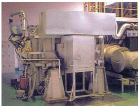
(溶解炉・・・銀を精錬し抽出します)
