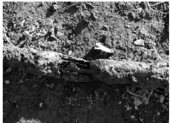
図3 腐食した配管
