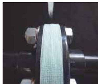
端部を押し付けて固定します
